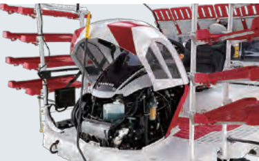
■ ボンネットハッチオープン ワンタッチで大きく開閉できます。
