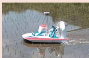
ラジコンボート(粒剤散布装置装着)
